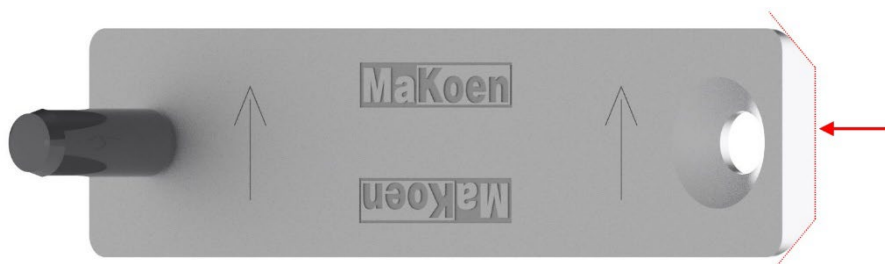
6 attēls: Mērījumu nolasīšanas mala
