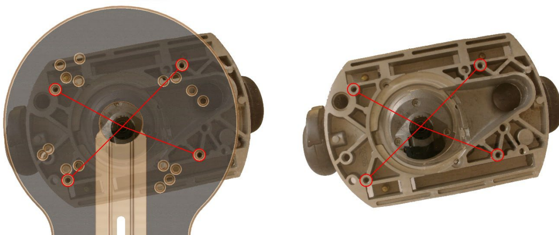
Afbeelding32 : gatenpatroon voor DW625 - afzuiging aan de linkerkant
