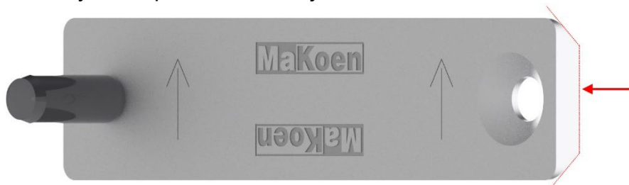
Obrázok6: Hrana na odčítanie nastaveného rozmeru
