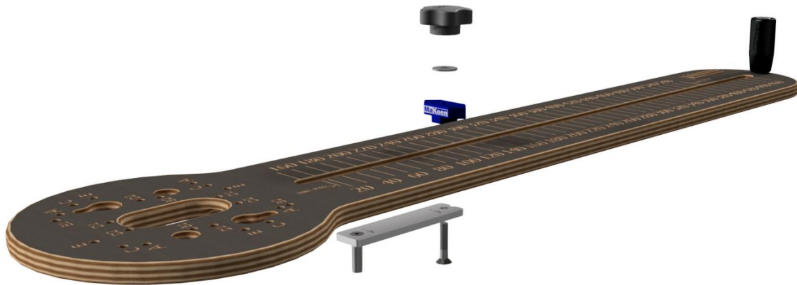
5Figura - Sequenza di montaggio del cerchio di fresatura GKF
