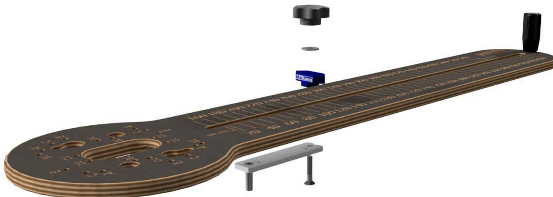
5Attēls - Frēzēšanas apļa GKF montāžas secība
