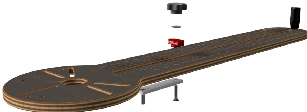
5attēls - Frēzēšanas apļa GOF-POF montāžas secība
