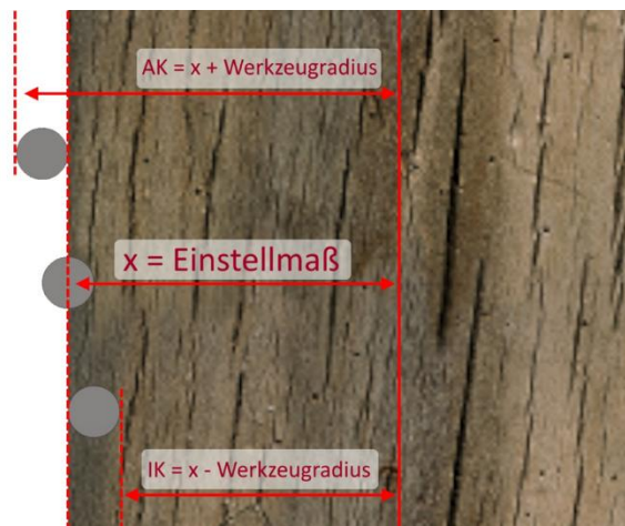
Figuur 4- Illustratie van buitencontour naar binnencontour
