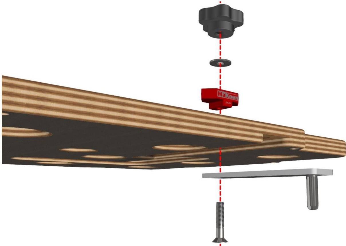
Figura 1: Orden de colocación del carro deslizable en la plantilla MFT
