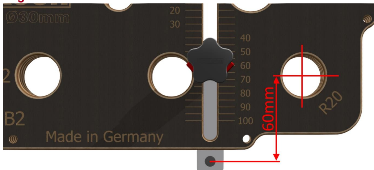
Figura 2 - Significato della misura impostata di 60 mm
