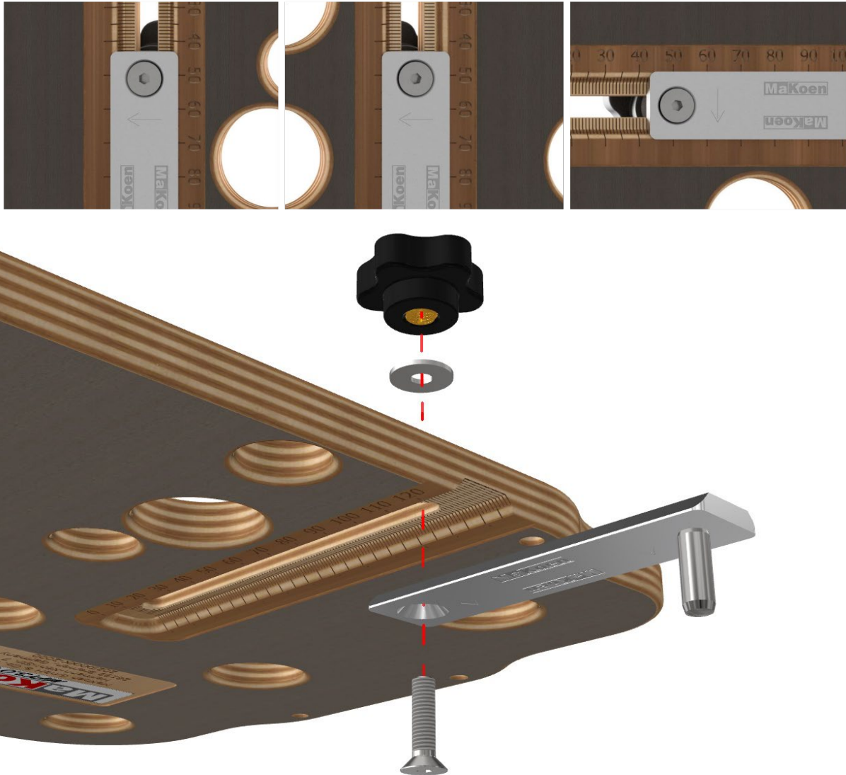
Illustration1 : Ordre d'insertion du chariot coulissant dans le gabarit MFT
