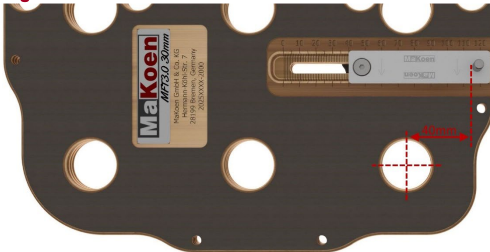
Illustration2 : signification de la mesure réglée de 40 mm
