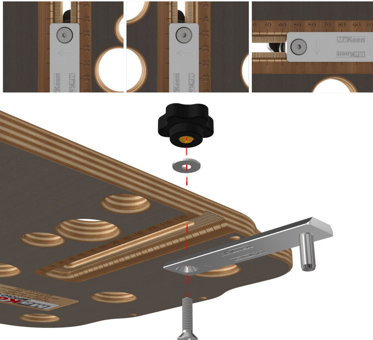
Figura1 : Ordine di inserimento della slitta scorrevole nella dima MFT
