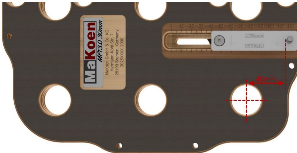
Afbeelding2 : betekenis van de ingestelde maat 40 mm
