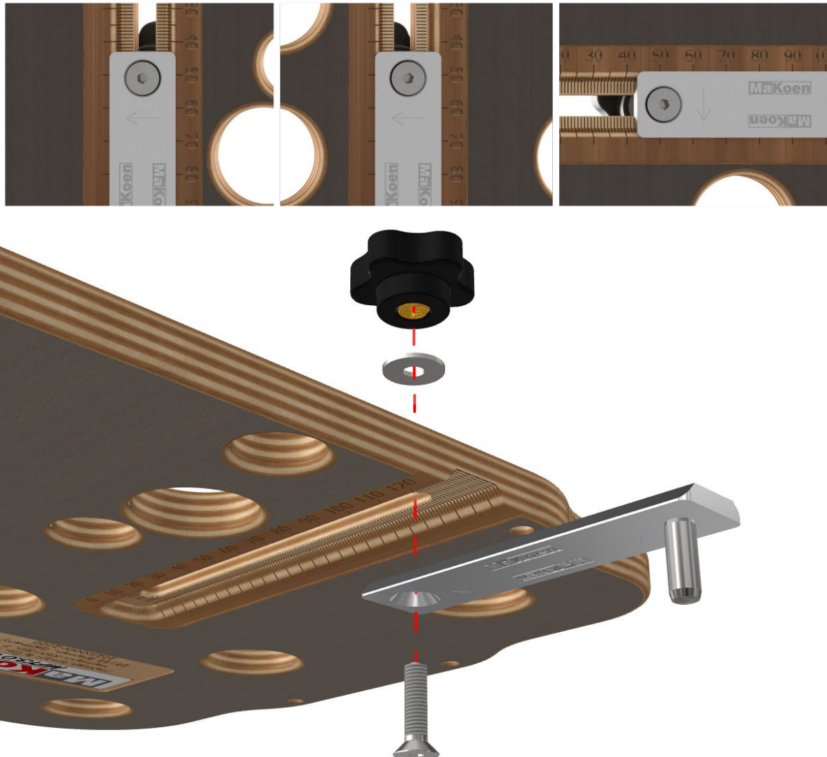
Afbeelding1 : Volgorde van plaatsing van de glijschoen in het MFT-sjabloon
