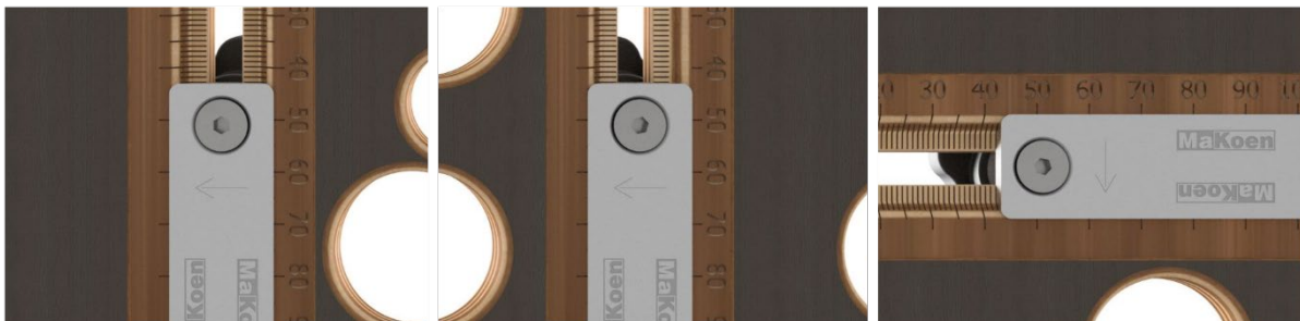
Afbeelding5 : instelling van alle drie de glij schoenen
