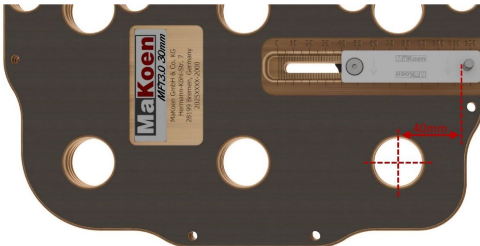
Obrázok2 : Význam nastaveného rozmeru 40 mm
