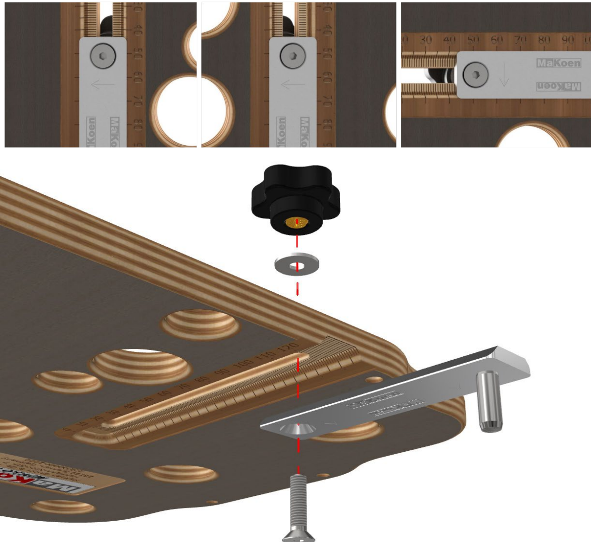
Figura1 : Orden de colocación del carro deslizante en la plantilla MFT
