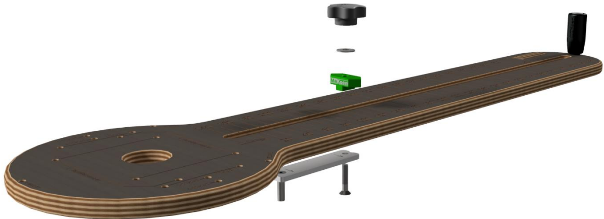
Figura 5- Secuencia de montaje del centro del tambor de fresado OF
