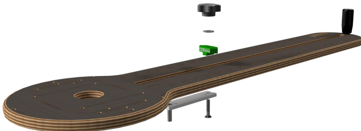
5attēls - Frēzēšanas cilindra apļa montāžas secība OF
