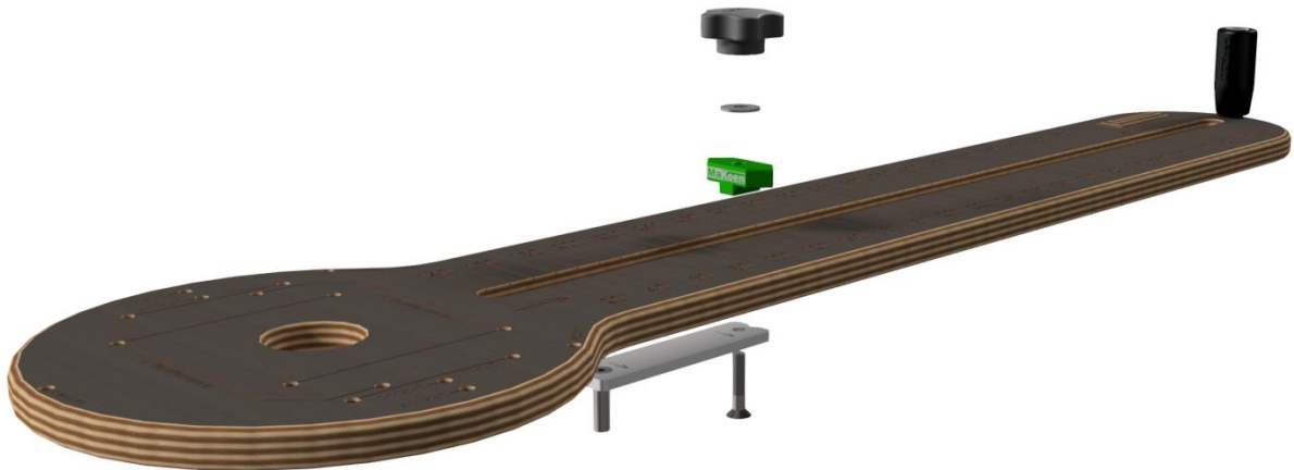
Obrázok 5- Postup montáže stredového frézovacieho bubna OF
